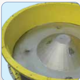
Waschkammer mit verschleißfester SINT® Polymer Auskleidung
