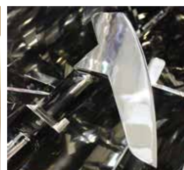
Polissage interne en acier inoxydable 304L / 316L
