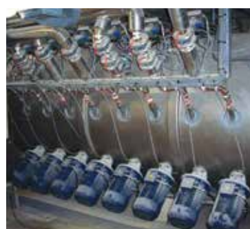
Hachoirs, injecteurs de liquide, gaine thermique
