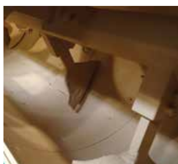
Revêtement intérieur de la cuve détachable, outils en matériau spécial anti-usure
