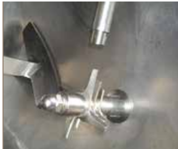
Injetores de líquido e agitadores de alta velocidade
